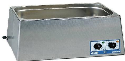
*Nota: Para la limpieza de objetos largos cuya longitud supere la de la cubeta, tales como tubos, pipetas, etc., se ha comprobado que se someten al mismo efecto de cavitación introduciéndolos en una probeta llena de líquido, colocada en sentido vertical dentro del baño.*
