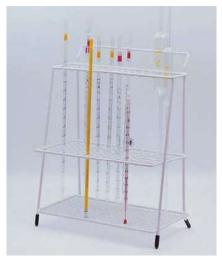
**SOPORTE PARA PIPETAS "SOP-PIP"** En alambre de acero inox. AISI 304. Para 112 pipetas de diferentes tamaños. Código 1001223
